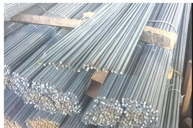
電気炉では主に鉄筋を製造(電気炉率100%)
